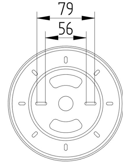
Mit Hilfe der Montageplatte den Lochabstand an die Decke anzeichnen. (Mindestabstand 56 mm, Höchstabstand 79 mm) Stellen Sie sicher, dass im Bereich der Bohrlöcher keine Stromführenden Leitungen befinden.
