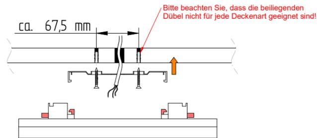
Schrauben Sie nun die Montageplatte an die Decke (in gewünschter Position)
