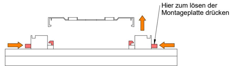
Montageplatte durch Drücken der roten Knöpfe an den Seiten lösen und zum Anzeichnen der Bohrlöcher verwenden.
