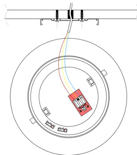
Führen Sie jeweils die Wechselstromkabel AC-L und AC-N, sowie das Erdungskabel in den Klemmenblock ein und schließen Sie die Abdeckung.
