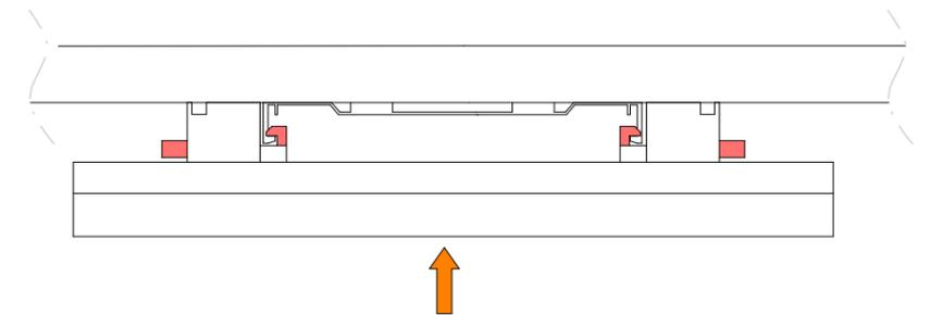
Nun können Sie die Leuchte an die Montageplatte andrücken, diese rastet von selbst ein. Stellen Sie sicher, dass der Deckenanbaustrahler fest an der Decke sitzt und schalten Sie den Strom ein.
